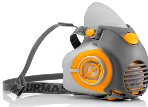
ETNA è una semimaschera di taglia universale conforme alla norma Europea EN 140:1998, in accordo alla Direttiva 89/686/CEE, dotata di due raccordi rapidi a baionetta, per filtri serie 2000, idonea per la protezione da polveri sia grossolane che sottili, da gas e vapori organici, inorganici, acidi e combinazioni di gas e polveri.
